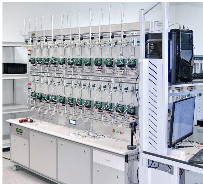
Стенд прогона приборов учета электроэнергии
