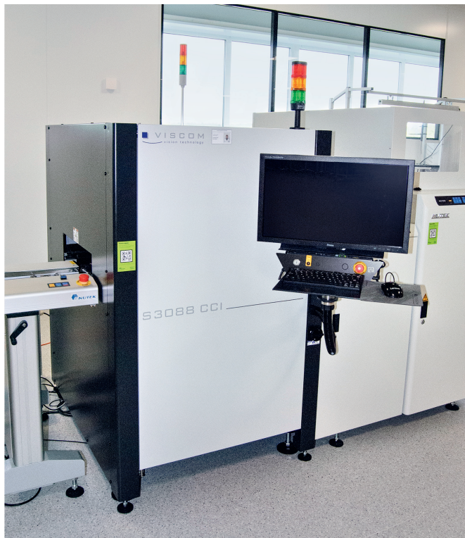
Система автоматической инспекции нанесения покрытия S3088 CCI компании Viscom
